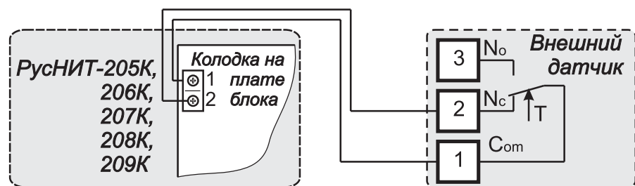
Рис. 9. Схема подключения выносного датчика температуры.
